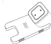
⑬ (可选) 将除胶器较大缺口处插入报警底座旋转90°，3M胶即除去。
