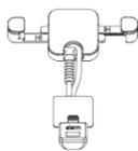
⑦ 将量取适宜长度的充电线插入爪子卡线位。
